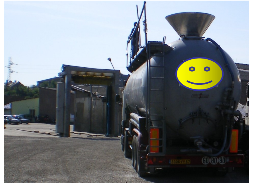
4. Nettoyage de la citerne : jet d'eau + rouleaux
