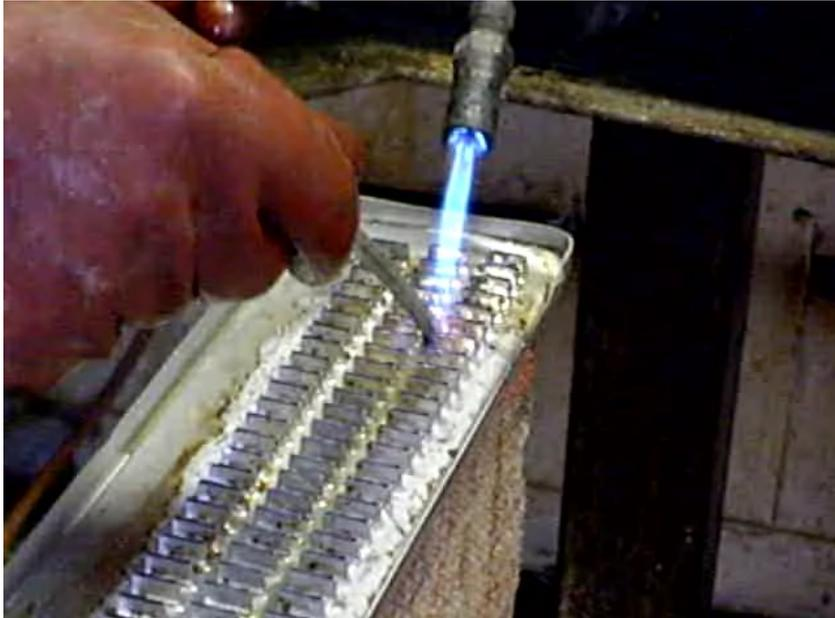
4. Remontage / assemblage des éléments par brasage
