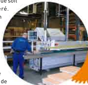
Plaqueuse de chants avec aspiration : 0,34 mg/m 3
