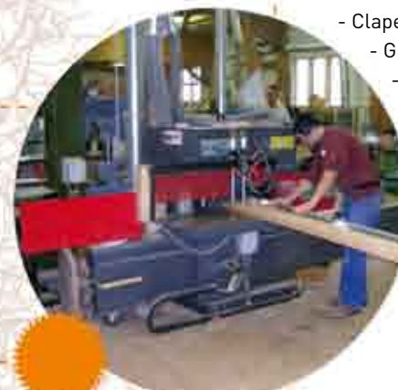
Tenonneuse – débit d'air : 3000 m 3 /H
